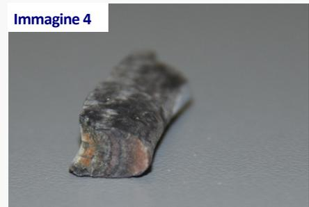
**È quindi evidente che l'uso di un acido consente solo la rimozione di una piccola parte del deposito ed è solo in grado di portare temporaneamente ad un livello più basso la soglia della rumorosità, ma non è in grado di ripristinare il corretto scambio termico.**
