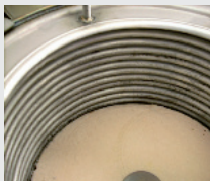
PULIZIA. Esempi a confronto di scambiatori sporchi e scambiatori che hanno subito il trattamento di pulizia con i prodotti alcalino prima e acido poi.
