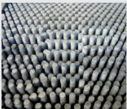
PULIZIA. Esempi a confronto di scambiatori sporchi e scambiatori che hanno subito il trattamento di pulizia con i prodotti alcalino prima e acido poi.
