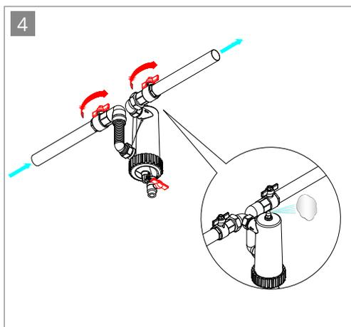
Se utilizzato per la pulizia a **SCARICO ZERO** (con impianto molto sporco) si consiglia l'installazione di un sistema con bypass.
