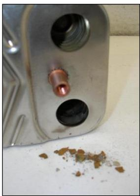
Nella foto a sinistra un particolare delle incrostazioni presenti in uno scambiatore di calore. L'intasamento ha reso necessaria la sostituzione del pezzo ma, prima di arrivare a ciò, lo scambiatore non trasferiva all'acqua tutto il calore fornito dalla combustione e la circolazione dell'acqua era sicuramente ridotta.
