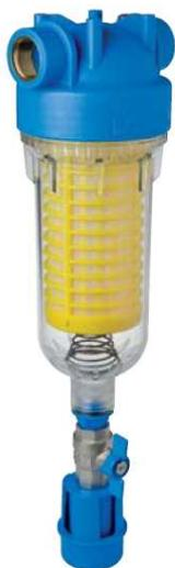
Il sistema di lavaggio in controcorrente della cartuccia permette la facile rimozione delle impurità dalla superficie filtrante. L'operazione di pulizia avviene manualmente, con l'apertura della valvola a sfera posta sullo scarico sul fondo del filtro. I filtri HY sono completi di:
